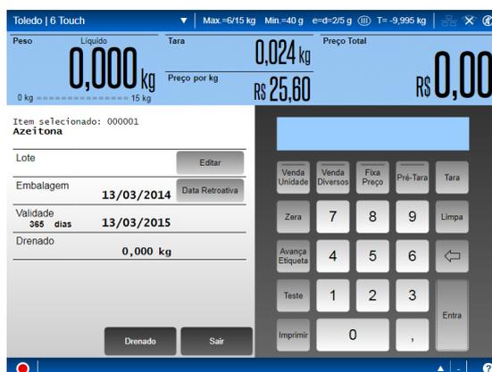
Neste momento, adicione ao recipiente as azeitonas drenadas. O peso das azeitonas drenadas será exibido no display. Pressione "Drenado" como indicado e será o valor impresso como peso drenado. Pressione "Drenado".
