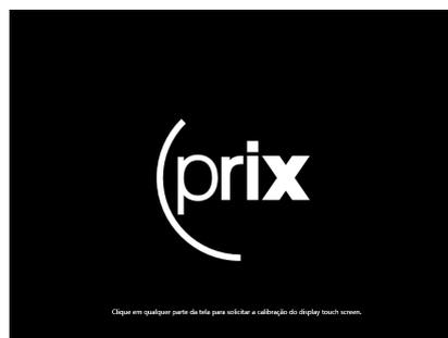
Abaixo da logo, estará exibindo a mensagem "Clique em qualquer parte da tela para realizar a calibração do display touch screen.". Caso necessite realizar a calibração, pressione em qualquer parte da tela e aguarde.
