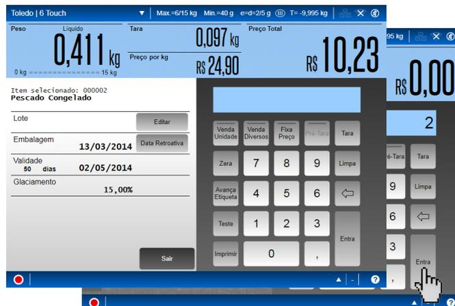
Automaticamente a balança irá calcular o valor do peso a ser descontado, correspondente ao percentual de glaciamento do produto "Pescado Congelado" e o subtrairá do peso bruto (peso líquido+água), indicando momentaneamente o resultado (peso líquido) no display. Uma etiqueta será impressa com as informações de Tara (recipiente+teor de água), recipiente, teor de água, peso líquido, preço/kg e valor total.
